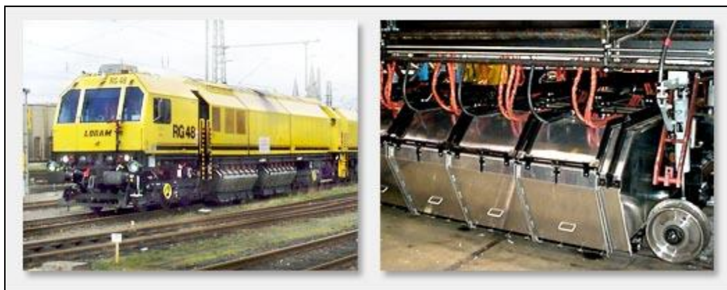
Rysunek 5. Widok maszyny do szlifowania szyn RG 48 I +II ( www.schweerbau.de/ ).
